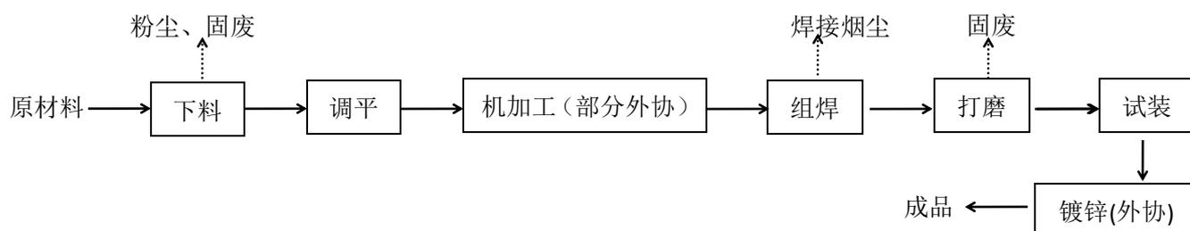
图 3-1 工艺流程及产污节点
