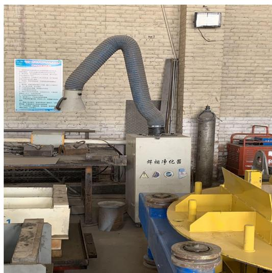
图 4-2 焊烟净化器
