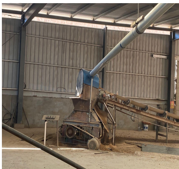
图 4-3 破碎集气装置
